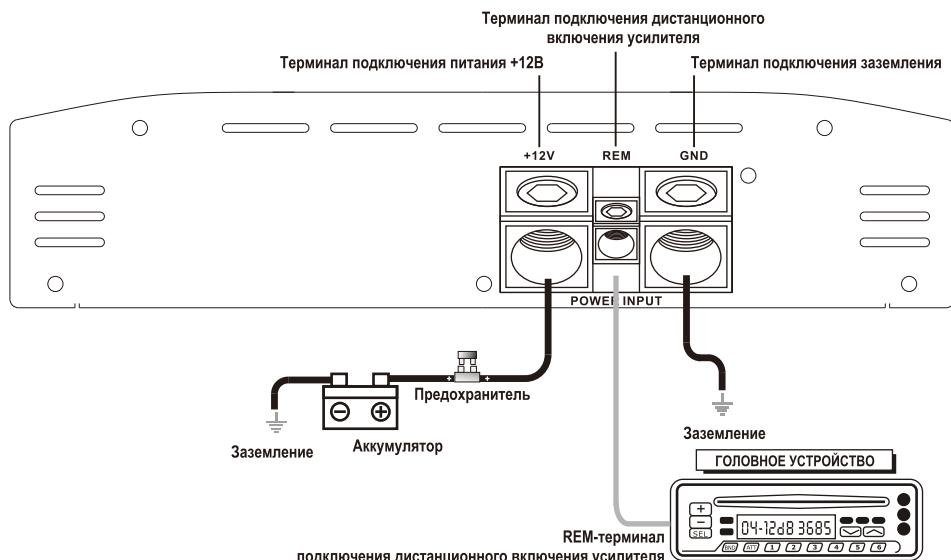
Т.к. усилитель чувствителен к работе двигателя и других механизмов, что может сказаться на качестве воспроизведения, старайтесь устанавливать его на расстоянии не менее 90 см от ресивера. Для установки используйте зоны под сиденьем, в багажнике и задней части салона автомобиля.
